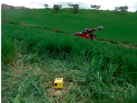
foto 7-8: esecuzione rilievo sismico passivo con tecnica HVSR e registrazione mediante tromografo digitale
