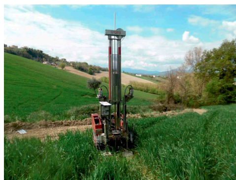
foto 1-2: esecuzione prova penetrometriche, statica continua (Cpt1) e dinamiche super pesanti (Dpsh1, Dpsh2 e Dpsh3)
