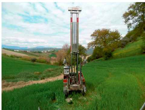
foto 1-2: esecuzione prova penetrometriche, statica continua (Cpt1) e dinamiche super pesanti (Dpsh1, Dpsh2 e Dpsh3)
