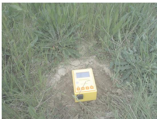
foto 4 - registrazione sismica passiva con Tromografo digitale -stazione Tr2
