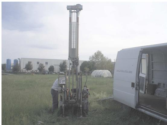
foto 1 - esecuzione prova penetrometrica Cpt1
