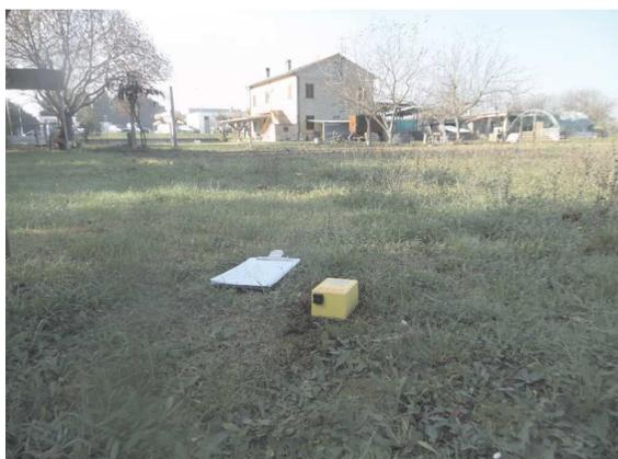
foto 4 - registrazione sismica passiva con Tromografo digitale -stazione Tr3
