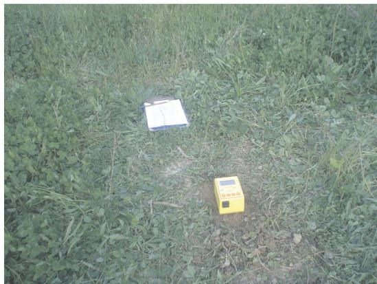
foto 2 - registrazione sismica passiva con Tromografo digitale -stazione Tr1
