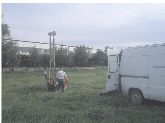
foto 3 - esecuzione prova penetrometrica Cpt2
